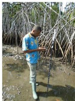
Géo-localisation (GPS) du point d'encrage de poteau gradué pour le suivi de la dynamique de la marée et taux de sédimentation du site Mponlogwé
