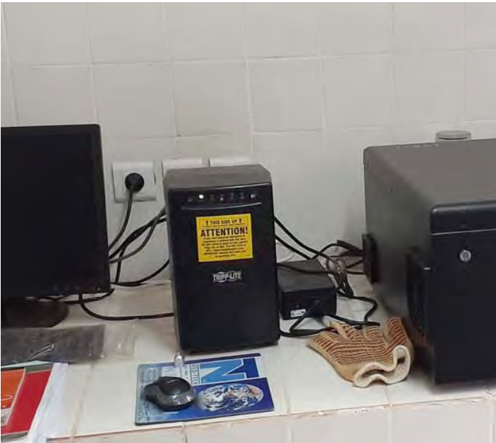
UPS-Alimentation sans coupure indispensable pour les équipements sensibles
